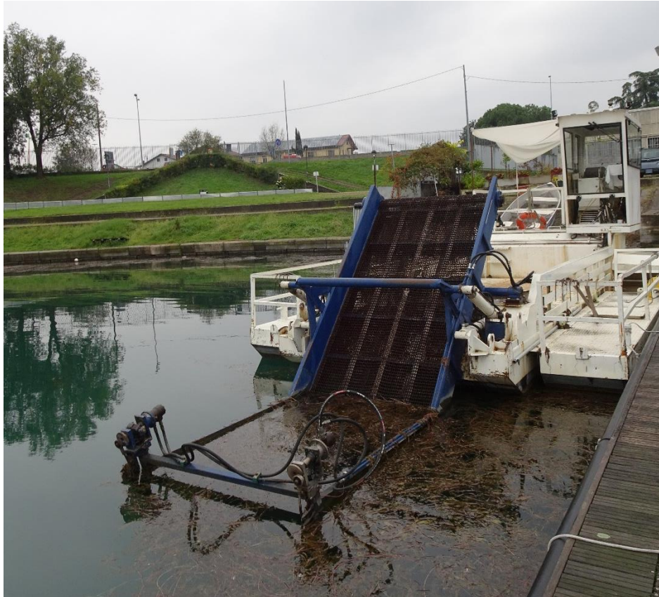
Natante in dotazione presso l'Idroscalo dotato di barre falcianti e nastro raccogliitore
