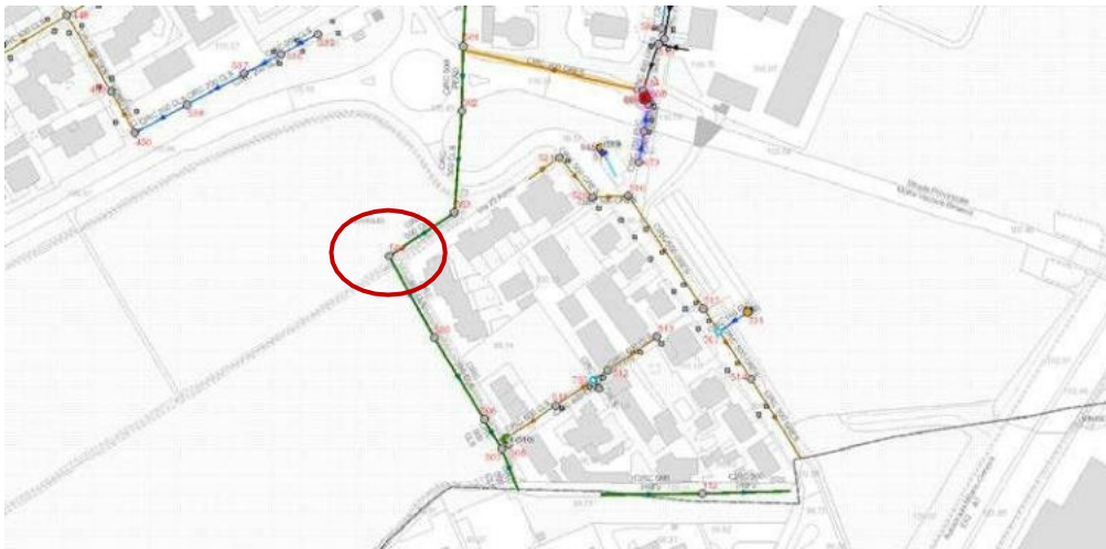
Figura 18 Planimetria della rete di fognatura esistente (Gruppo CAP); il punto di recapito è il pozzetto 504
